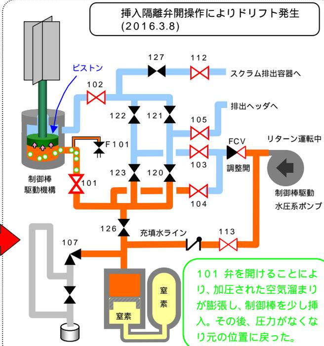
柏崎刈羽原子力発電所 5 号機 「制御棒の動作 推定メカニズム」
