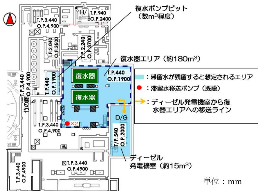
図－１ 1号タービン建屋で最低排水レベルまで移送した場合の建屋内滞留水の残水量（2016 年 2 月現在）
