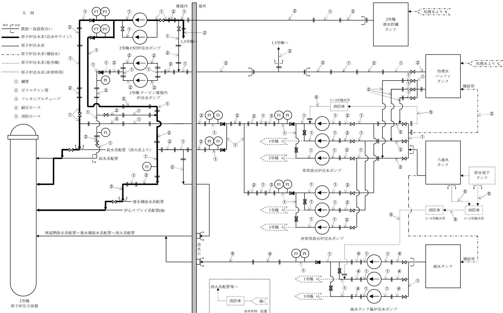
図-2 2号機原子炉圧力容器・格納容器注水設備系統概略図
