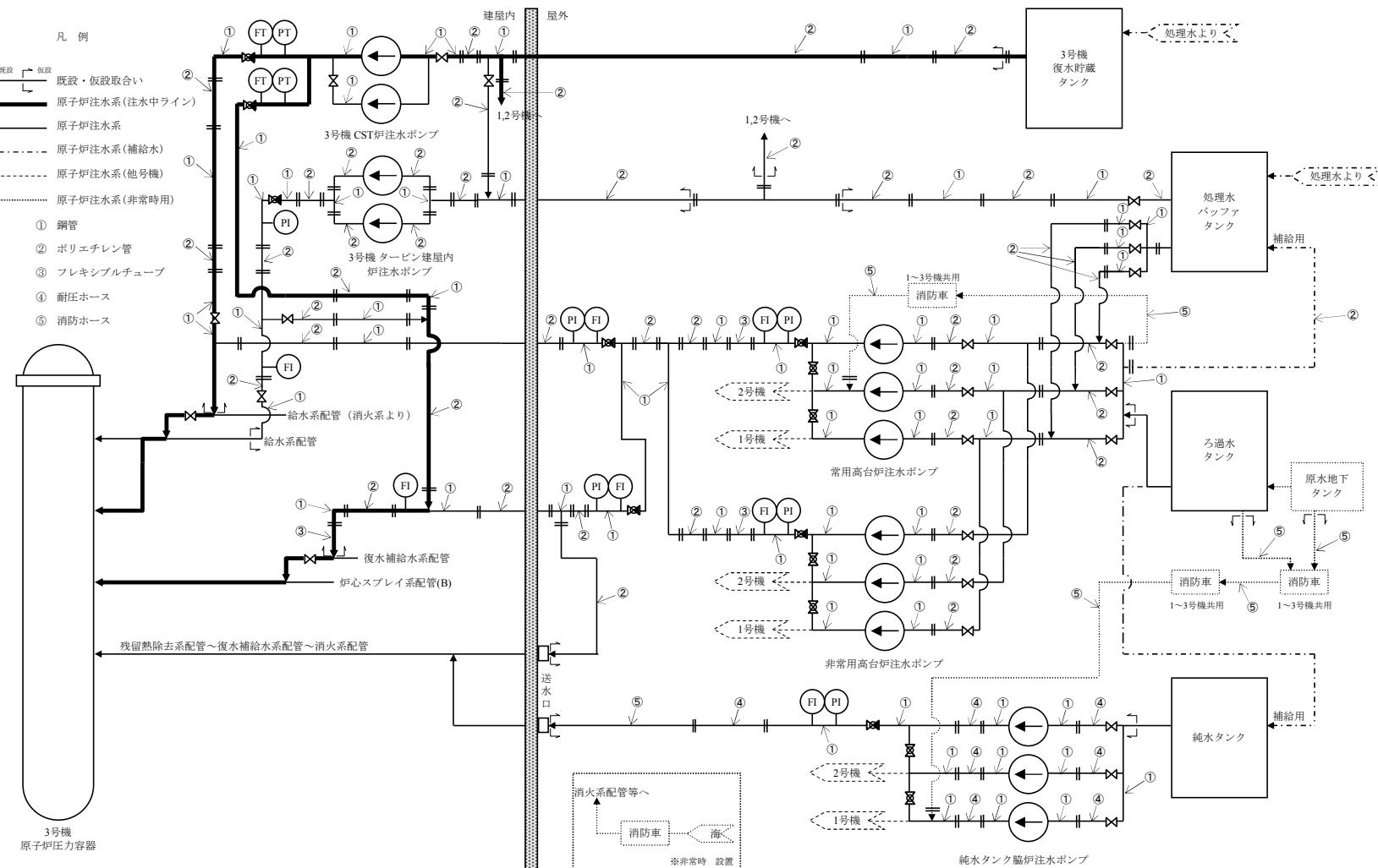
図-3 3号機原子炉圧力容器・格納容器注水設備系統概略図
