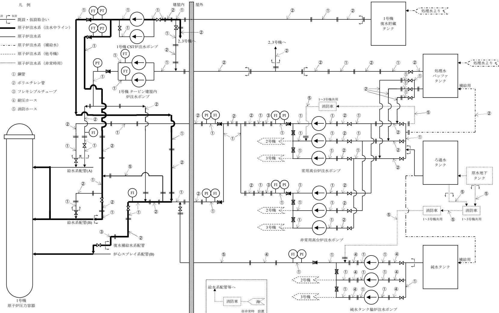
図-1 1号機原子炉圧力容器・格納容器注水設備系統概略図
